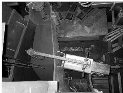
Bild 5. Anodenträgergießofen in der Montage (Ausschnitt mit Stopfeinrichtung und Zuführinnen)
