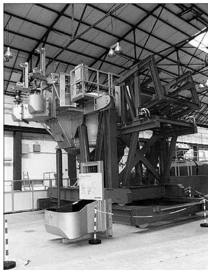
Bild 3. 20-t-Gießofenanlage mit zwei wechselbaren Doppelstopfen und Einfüllstand
